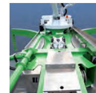
L'espace au milieu de la superstructure permet un accès facile à toutes les pompes hydrauliques et conduites.
