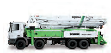
Une économie de place et de temps. Les stabilisateurs sont rapidement déployés. Ils ne sont ni télescopiques ni rabattables et passent dans les brèches les plus étroites.
