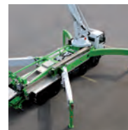
Seul le système de stabilisation « super SX » permet l'implantation d'un groupe de pompage à longue course. Cela signifie moins d'inversions du système hydraulique une usure réduite et un plus haut rendement.
