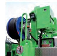
L'opérateur visualise toutes les pressions. Compresseur, eau et commutateur « entretien » sont toujours à portée de main pour le remplacement du cylindre de refoulement.
